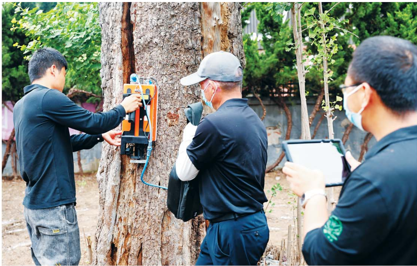
6月30日，技术人员对树干进行B超检测，查看内部腐烂情况。
