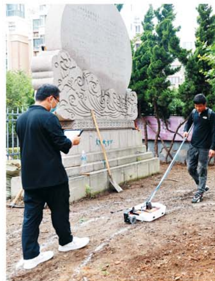
6月30日，技术人员对古树根部进行B超检测。
