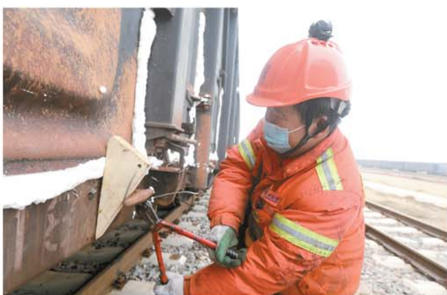
师傅正在用木块封紧闸口。
