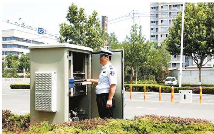
首个固定式机动车排期遥感监测设备。
