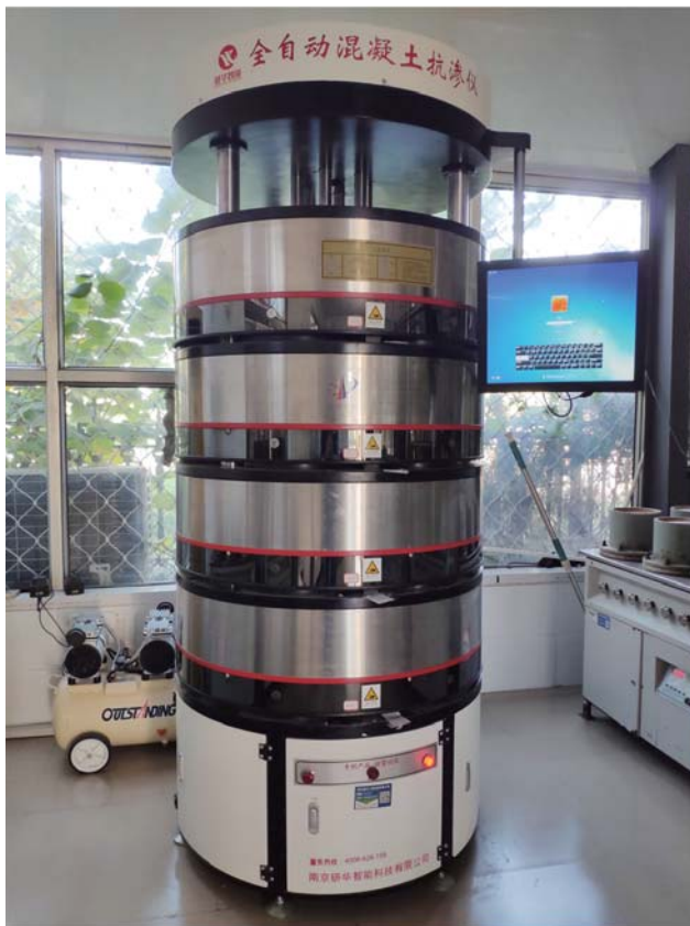
采用一拖四全自动混凝土抗渗仪,提高了检测准确度和工作效率。
