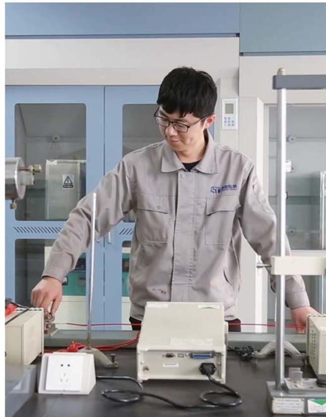
实验员测量样品导体电阻,评定样品电阻是否合格。
