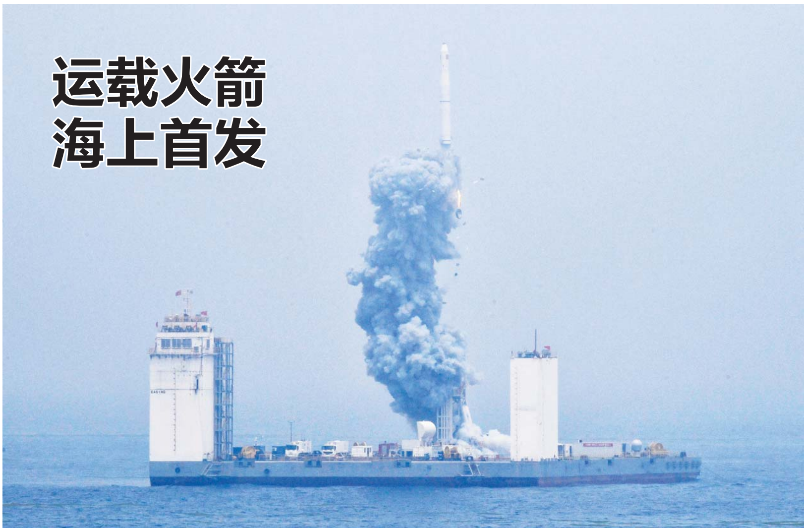
6月5日12时6分,我国在黄海海域采用长征十一号海射型固体运载火箭,以民用船舶为发射平台,将技术试验卫星捕风一号A、B星及五颗商业卫星顺利送入预定轨道,试验取得成功。这是我国首次在海面上实施运载火箭发射技术试验。
