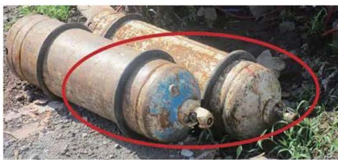
乙炔瓶未保持直立储存,在太阳下暴晒,可能造成火灾、容器爆炸事故。
