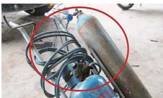
氧气瓶和液罐使用状态下距离不足5米,氧气减压器压力表损坏失效,胶管未区分,使用同一种颜色胶管,可能造成火灾、容器爆炸事故。
