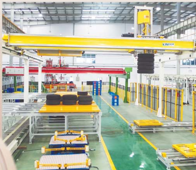
科捷研发的橡胶轮胎智能分拣系统。
