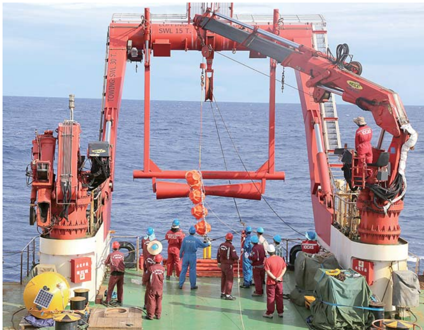
科考队员进行深海潜标玻璃浮球和声学释放器的回收。
