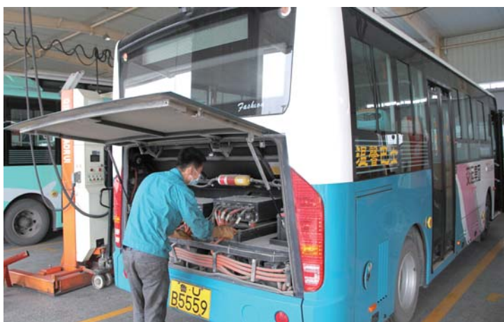
修理人员检查线路。
